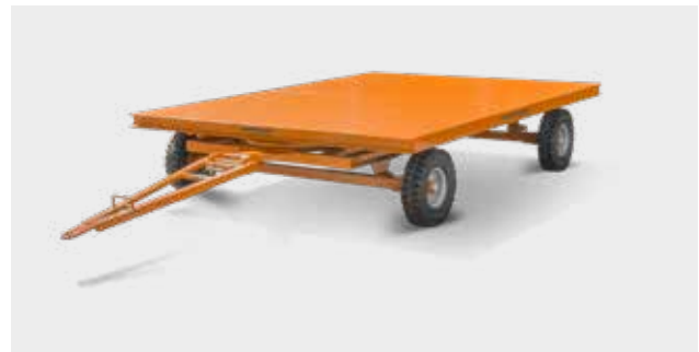
Vielseitiger Transportanhänger mit Drehschemellenkung und individuell wählbarer Ladefläche aus Holz, Stahl, Riffelblech, Antirutschbelag oder Kunststoff.
